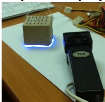
Рисунок 3. Измерение мощности излучения компактной светодиодной УФ облучательной установки
