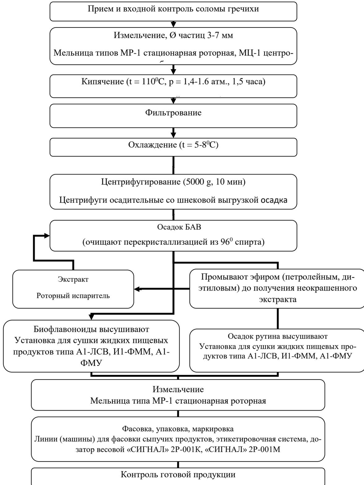
**Рисунок 1. Технологический процесс производства биофлавоноидов и рутина из соломы гречихи**
