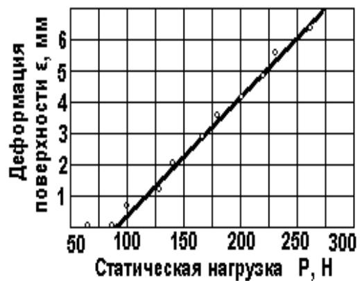
Рис.2. Остаточная деформация при воздействии статической нагрузки на плод дыни рабочей поверхности в виде цилиндра диаметром 50мм и длиной 60м
